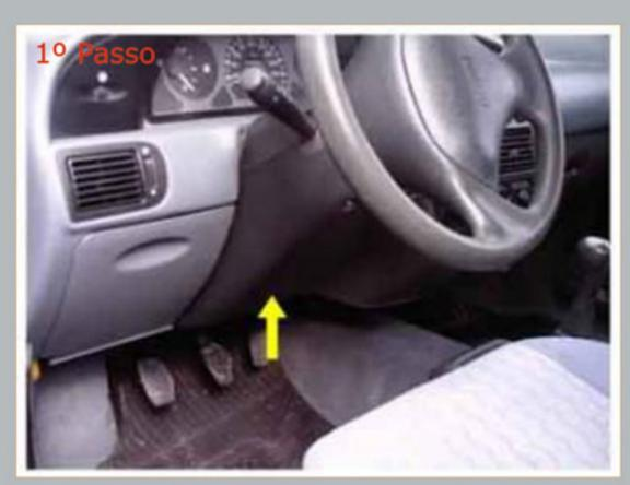
El filtro está localizado próximo al pedal del acelerador.
